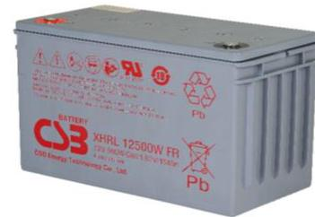
XHRL 12500W FR - батарея с высокой энергоёмкостью. Особенная кристаллическая решетка электродов позволила увеличить на 20% отдаваемую мощность по сравнению с батареями других серий. Она разработана для эксплуатации в режиме высоких токов разряда при коротком времени разряда. Увеличенный срок службы более 10 лет в буферном режиме (Более 12 лет при 20°C по классификации Eurobat) или более 260 циклов заряда-разряда в циклическом режиме при 100% разряде.
