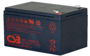
HRL 1250W - батарея с высокой энергоемкостью. Особенная кристаллическая решетка электродов позволила увеличить на 20% отдаваемую мощность по сравнению с батареями других серий. Она разработана для эксплуатации в режиме высоких токов разряда при коротком времени разряда. Срок службы: более 8 лет в буферном режиме (10/12 лет при 20°C по классификации Eurobat) или более 260 циклов заряда-разряда в циклическом режиме при 100% разряде.
