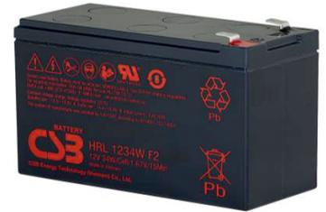
HRL 1234W - батарея с высокой энергоемкостью. Особенная кристаллическая решетка электродов позволила увеличить на 20% отдаваемую мощность по сравнению с батареями других серий. Она разработана для эксплуатации в режиме высоких токов разряда при коротком времени разряда. Срок службы: более 8 лет в буферном режиме (10/12 лет при 20°C по классификации Eurobat) или более 260 циклов заряда-разряда в циклическом режиме при 100% разряде.
