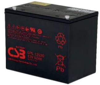
GPL 12520 - батарея общего применения со сроком службы более 10 лет в буферном режиме (Более 12 лет при 20°C по классификации Eurobat) или более 260 циклов заряда-разряда в циклическом режиме при 100% разряде. Аккумуляторы серии GPL не требуют обслуживания, долива воды, имеют низкий уровень саморазряда и высокую надежность; могут многократно перезаряжаться.
