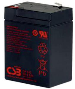
GP 645 - батарея общего применения со сроком службы 5 лет в буферном режиме или более 260 циклов заряда-разряда в циклическом режиме при 100% разряде. Как и все батареи CSB, она перезаряжаемая, высокоэффективная и не требующая обслуживания. Благодаря специальной формуле производства свинцово-кальциевого сплава и технологиям изготовления - уменьшается процесс газообразования.
