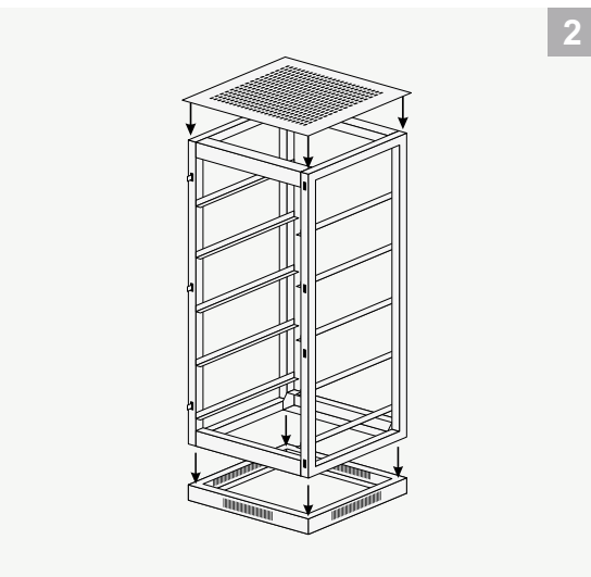
Установка на цоколь и крышки
